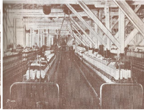
Foto 4: Sección de husos de hilandería en la Fábrica de Tejidos de Algodón de Espriella & Cia., con los que se producía la hilaza para el tejido de medias de seda, camisetas de algodón, driles y drilonés. Fuente: Álbum de Cartagena de Indias, 400 años 1533 - 1933.
